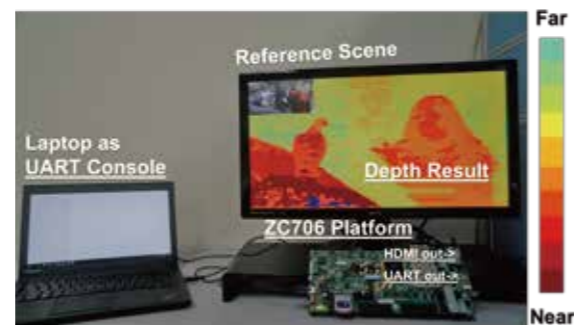
圖 1. 五鏡頭相機系統示意圖，及深度估計處理器在 FPGA SoC 平台上運作展示
